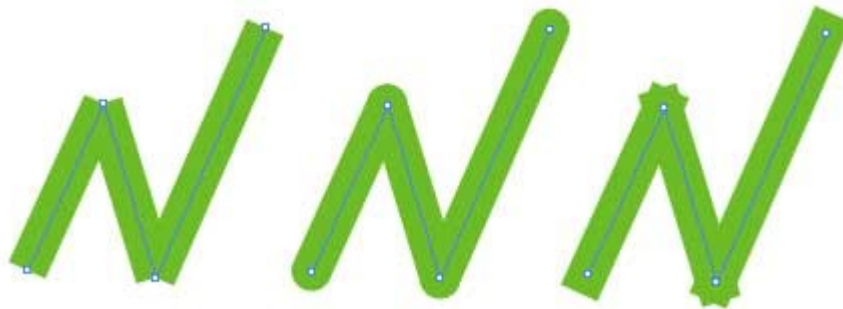
Рисунок 11. Приклад ліній з різним налаштуванням параметрів Cap і Join
