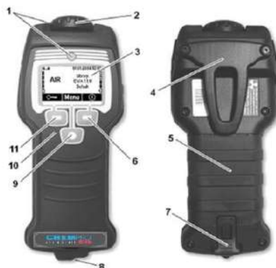
Рис. 3.25. Хімічний детектор ChemPro 100i:
