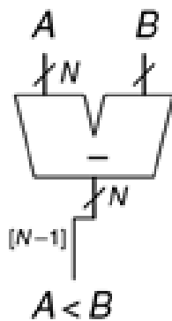
Рис. 8 N-розрядний компаратор величини
