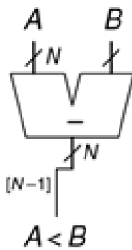
Рис. 2 N -розрядний компаратор величини
