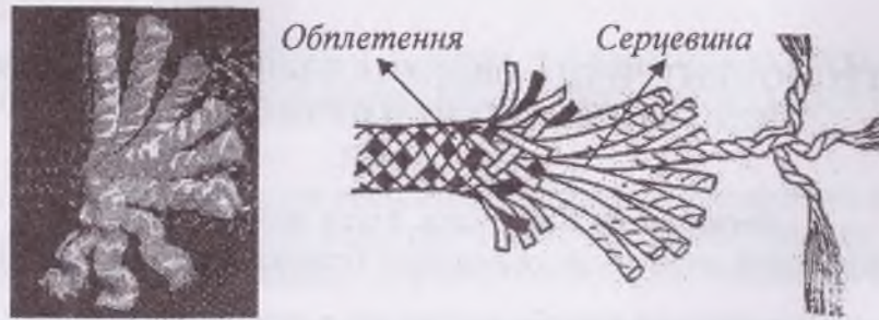
Рис. 1. Конструкція плетеної мотузки (кабельного типу)
