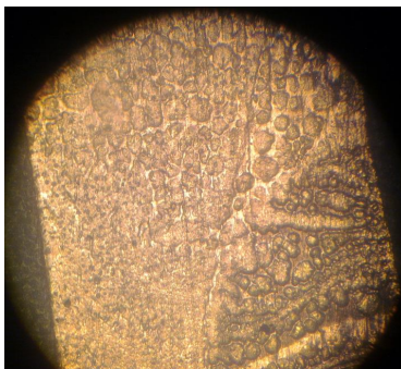
Рис.6. Мікроструктура мідного дроту після дії відкритого полум'я, t = 582 °С протягом 15 хв: а – травник №1 \times 200 ; б – травник №2 \times 200
