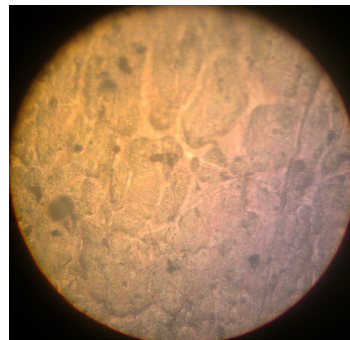
Рис.5. Мікроструктура мідного дроту після пропускання струму I = 400 А, протягом 10 с і дії відкритого полум'я t = 582 °С протягом 15 хв: а – травник №1 \times 200 ; б – травник №2 \times 500
