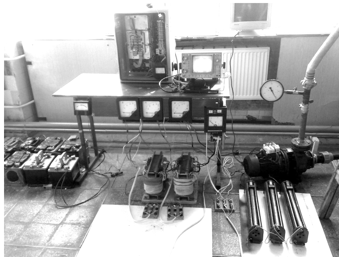
Рис.5. Експериментальна установка автономного живлення АД
