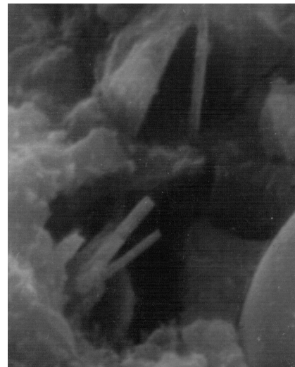
Рис. 2. Мікроструктура каменю на основі портландцементу ПЦ І-500, гідратованого 7 діб
