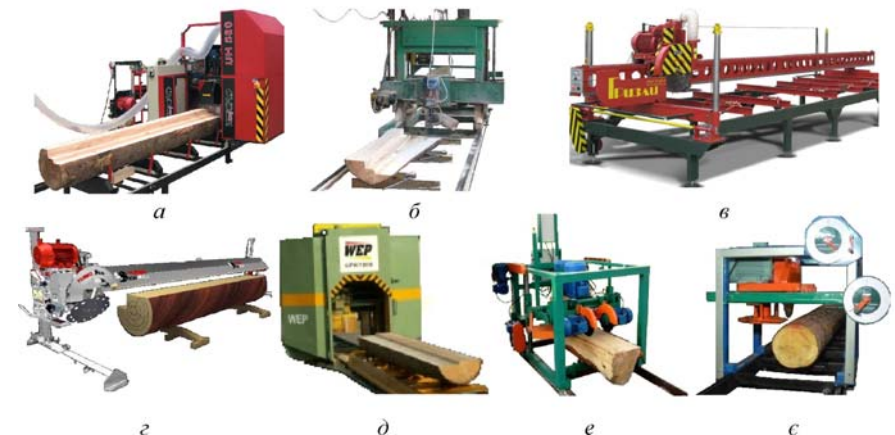
Рис. 1. Загальні вигляди круглопилкових верстатів ортопиляння: а – УН-500 фірми "StrojCAD" (Словаччина); б – Ясень-Баракуда фірми "Ясень" (Україна);
