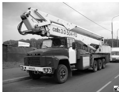
Рис. 2. Колінчастий підйомник “Челла” (АКП-50(250) “CELLA spr”)
