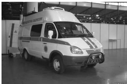
Рис. 1. Пересувна хіміко-радіологічна лабораторія ДСНС України (на базі ГАЗ-2705)
