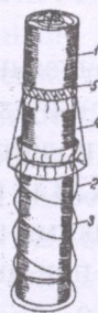
Рис. 1.4. Просочування стовпа у підставній ванні із захистом її краю від випаровування ХЗЗ:
