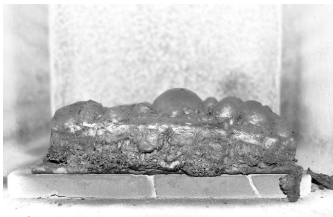
Рис. 1. Спучений шар вогнезахисного покриття інтумесцентного типу, нагрітого до температури 600°C
