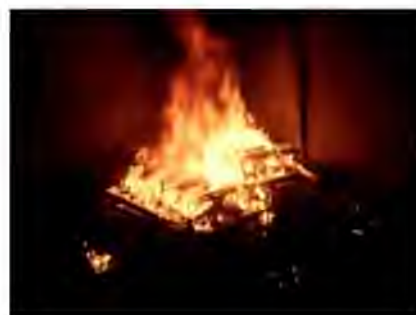
Рис. 4. Вогнище пожежі під час виконання експериментальних досліджень в закритому приміщенні
