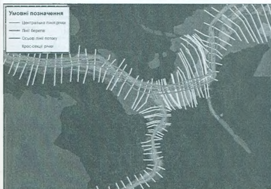
Рис. 1. Карта цифрової моделі рельєфу з нанесеними геометричними об'єктами в ArcGIS за допомогою програмного забезпечення HEC-GeoRAS
