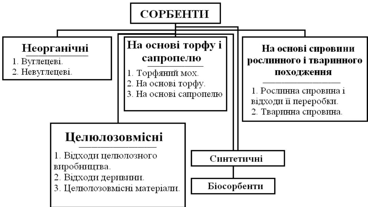
Рис. 1. Схема класифікації сорбентів (Глазкова, Стрельникова, 2003)
