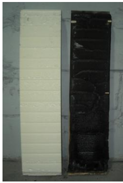
Рис. 2. Внешний вид образцов до и после испытаний по методу П ДСТУ Б В.2.7-19-95 (а- утеплитель PIR; б- сэндвич-панели и внутренний слой из утеплителя PIR)
