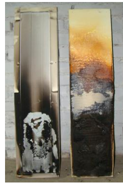
Рис. 2. Внешний вид образцов до и после испытаний по методу П ДСТУ Б В.2.7-19-95 (а- утеплитель PIR; б- сэндвич-панели и внутренний слой из утеплителя PIR)
