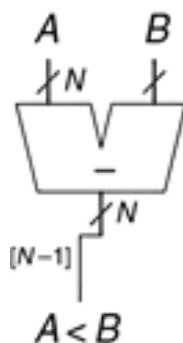
Рисунок 9.2 – N -розрядний компаратор величини
